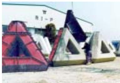
脱型した型枠は、ケレン棒・ウエス等で清掃した後、剥離材を塗り、次のコンクリート打設に備える。
