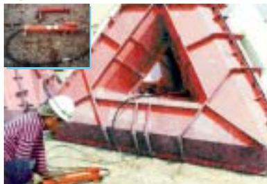
ボルト・ナット、万力をすべてはずし、外枠脱型金具・装置を装着後（3t以上）、ジャッキをかける。外枠は3枚すべて剥離してから1枚ずつ外すこと。
